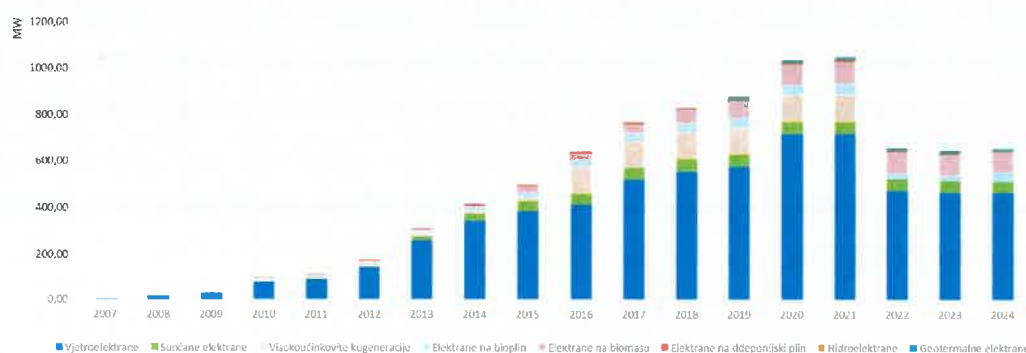
Slika 9. Instalirana snaga prema tipu proizvodnih postrojenja u pojedinoj godini (MW)
